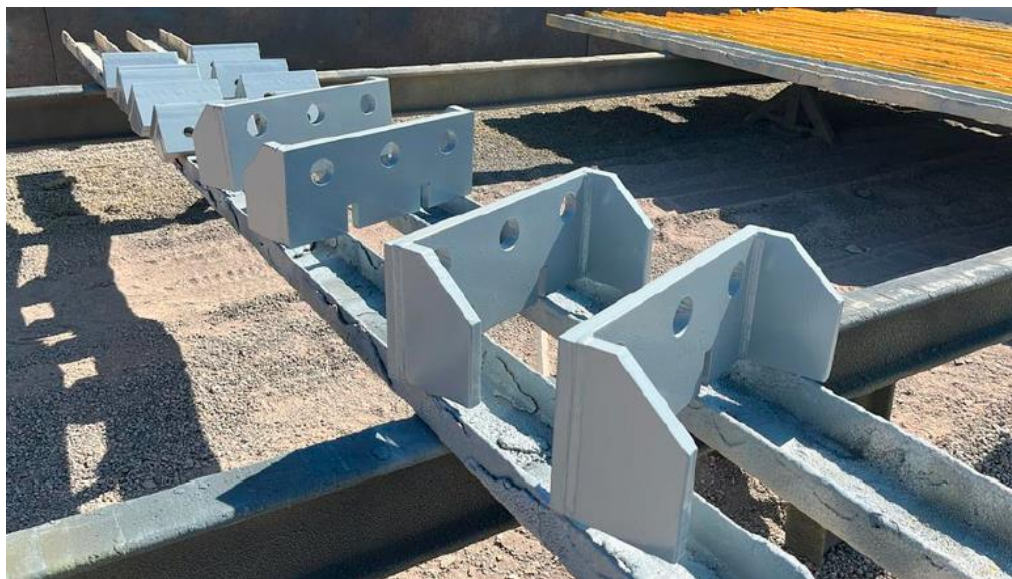
SOPORTES ANTISÍSMICOS GENERADORES
