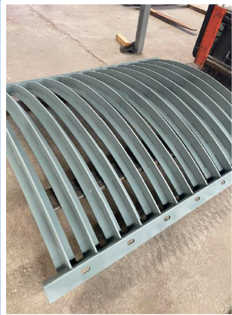
REFUERZO ESTRUCTURAL CÁMARA DE HDPE
